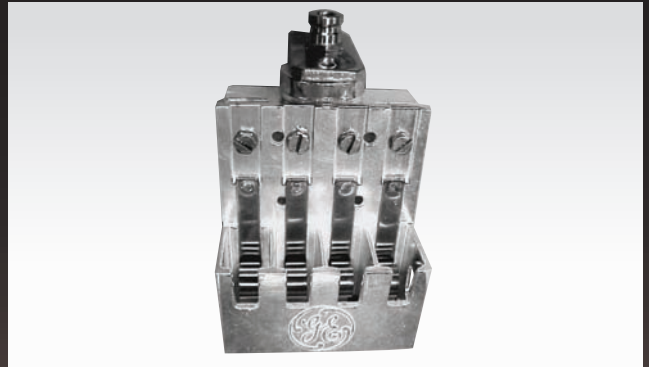
Reparación de Porta Escobillas
