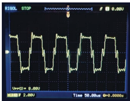
Motor sin Protección
